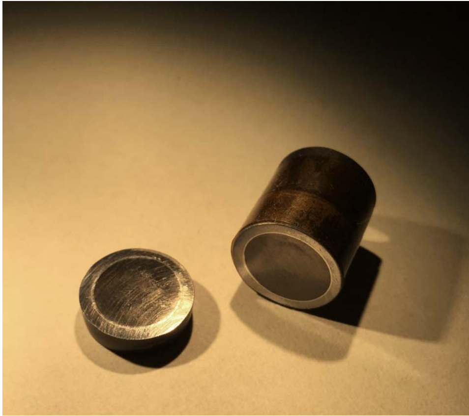
図2 試作した鉄系高温超伝導バルク磁石
