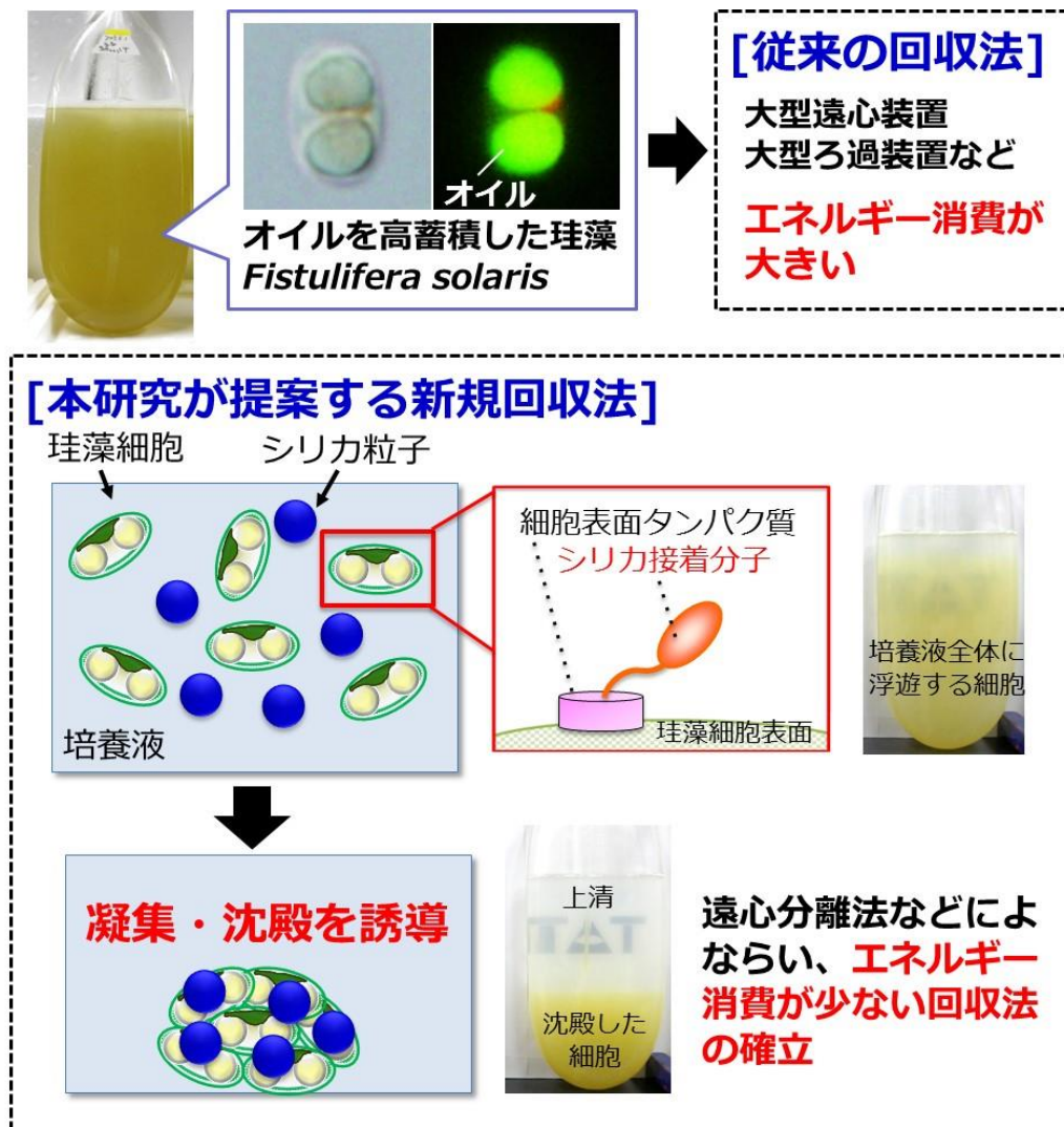
図1 本研究で提案する微細藻類の新規回収法。オイル高蓄積珪藻 Fistulifera solaris JPC C DA0580 株の細胞表面にシリカ粒子接着分子を固定化し、シリカ粒子を培養液に加えるだけで、細胞の凝集・沈殿を誘導することができます。
